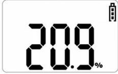
기기의 전원을 켜 후, 측정 모드에 들어서면 LCD화면에 가스의 농도 및 배터리잔량이 표시됩니다.
