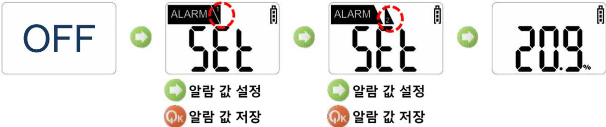
각 알람 설정 모드에서 전원 key를 누르면 해당하는 알람 값이 나타나고 화살표 key를 눌러서 알람 값을 변경하고 전원 key를 눌러서 알람 값 저장 및 자릿수 이동을 합니다. 마지막 자릿수까지 변경 완료한 후, 전원 key를 다시 누르면 알람 설정 모드로 복귀하게 됩니다.
