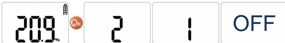
가스 측정 모드 이외의 모드(최댓값 모드/최솟값 모드/로그 모드 등)에서 전원 key를 누르거나 카운트다운이 끝나기 전에 전원 key에서 손을 떼면 전원이 꺼지지 않습니다.
