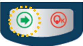
4가지 가스농도가 동시에 표시되고 있는 가스검지모드 상태일 때 화살표 key를 1회 짧게 누르면 LED Back Light가 점등되며 다시 한번 누르면 소등됩니다. 어두운 측정환경에서도 측정값을 볼 수 있습니다. Back light는 버튼동작이 없을 시 10초 후 자동으로 소등됩니다.
