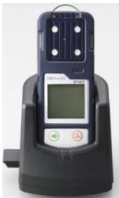
Battery 충전장치에 연결 시에는 반드시 전원 종료 후 Battery 충전장치에 연결하시기 바랍니다. 충전상태는 충전기의 LED를 통해 표시됩니다.
