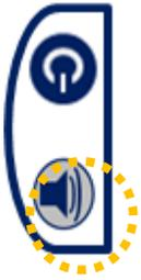
전원 key를 3초 동안 길게 누르면 3, 2, 1이 나타난 이후에 LCD상의 모든 아이콘이 3회 깜박이면서 기기의 버전이 표시됩니다. 60초 동안 기기의 안정화가 진행되고 안정화가 완료되면 **V**가 30초 동안 깜빡이고 가스 측정 모드로 진입됩니다.
