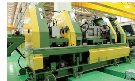
UT(Ultrasonic Test) Off-Line 검사
