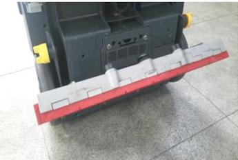
청소 및 유지보수 가 용이한 스퀴지 장착
