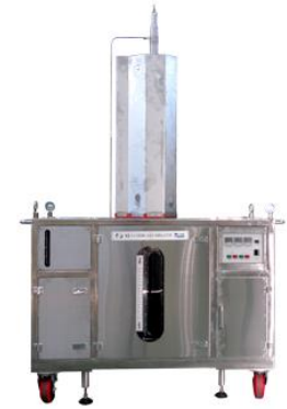
CEDM 시리즈 [원자력 제어봉의 구동 메커니즘을 실사처럼 테스트 할 수 있는 설비]
