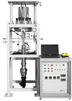
SERT/SSRT/CERT 시리즈 [부식/균열/인장에 대한 특성을 측정하는 설비]
