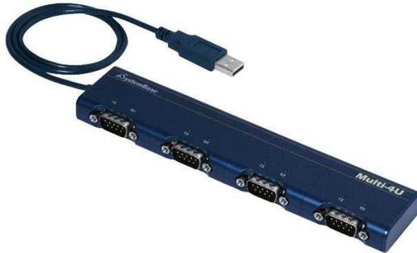
시리얼통신 전문회사 시스템베이스의 "Multi-4/microUSB 232"는 Android OS 3.2 이상을 지원하는 스마트폰 및 태블릿 PC를 통해 RS232 통신을 지원하는 제품입니다. 본 제품은 스마트폰 및 태블릿 PC의 Micro USB 커넥터에 연결하여 USB OTG 모드를 지원하는 제품으로, USB Specification 2.0을 지원합니다. "Multi-4/microUSB 232"는 DE9 커넥터를 통해 최대 921.6Kbps의 RS232 시리얼 통신 속도를 지원하며, 전원공급을 위한 외부 아답터 및 케이블이 없이도 활용 하실 수 있습니다.
