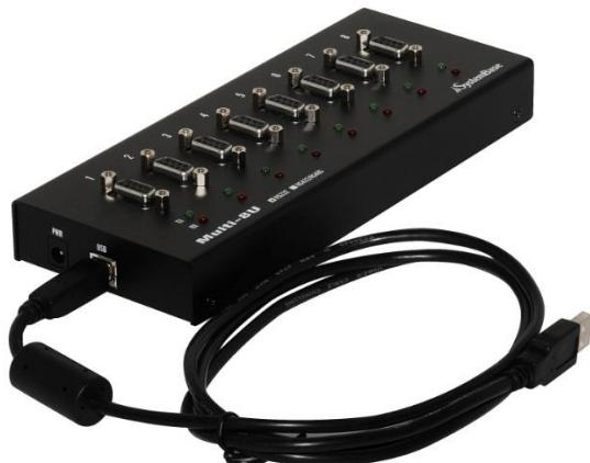
Multi-8U는 PC 의 USB 포트를 이용하여 8개의 시리얼 포트(COM 포트)를 추가해 주는 USB to Serial 컨버터 입니다. 1개의 USB 포트를 이용하여 8개의 RS232 또는 COMBO(RS422/RS485) 통신을 위한 serial포트를 생성할 수 있습니다. USB 방식을 사용하였기 때문에 설치와 제거가 간단하며, 통신 상태를 한눈에 파악할 수 있도록 TX/RX LED 가 제공됩니다. 또한 최고 통신 속도는 921.6Kbps까지 가능합니다.
